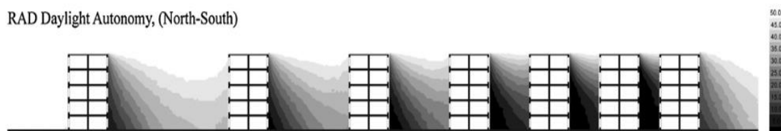
شکل 10- بررسی تأثیر نسبت ارتفاع ساختمان به عرض خیابان بر دریافت انرژی خورشیدی (Strømmandersen and Sattrup, 2011) Fig. 10-Investigation of the effect of building height to street width ratio on solar energy consumption (Strømmandersen and Sattrup, 2011)
