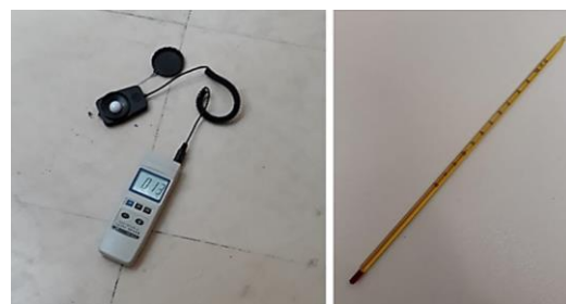
شکل 17- (سمت راست) دماسنج و (سمت چپ) لوکس متر مورد استفاده در تحقیق
