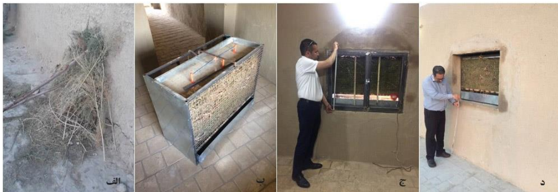
شکل 2- الف. خارخانه بومی منطقه سیستان، ب. خارخانه ابداعی نگارندگان با حداقل هزینه ساخت و مصرف انرژی، ج. نمای خارخانه ابداعی از داخل فضا، د. نمای بیرونی خارخانه ابداعی
