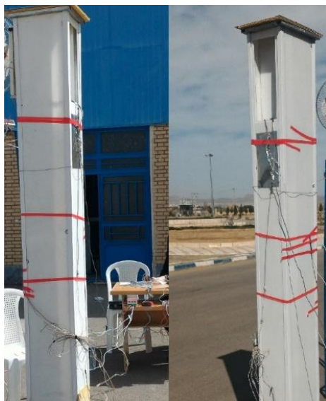
شکل 6- نصب سنسورهای اندازه‌گیری دما و شدت تابش با اتصال به کامپیوتر
