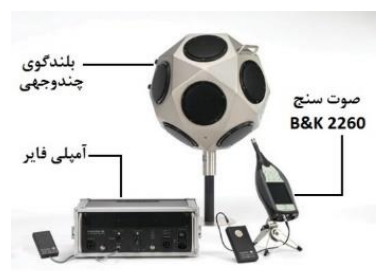
شکل 3- مجموعه بلندگوی چندوجهی، آمپلی‌فایر و صوت-سنج B&K 2260
