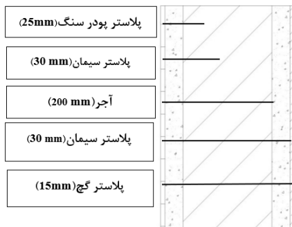
شکل 7- لایه بندی دیوار خارجی Fig.7- External wall layering
