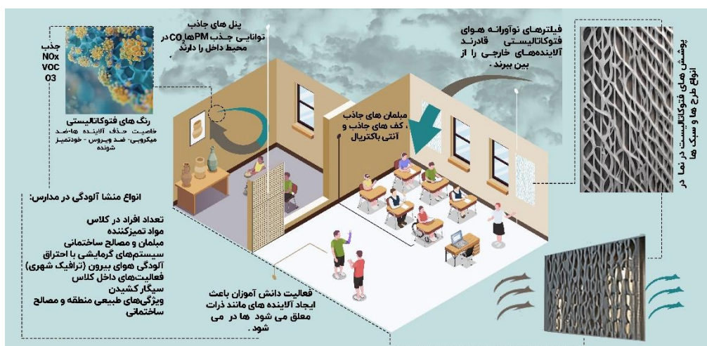
شکل 5 - استفاده از نانو ذرات در مصالح و متریال‌های داخلی برای حذف آلاینده‌ها
